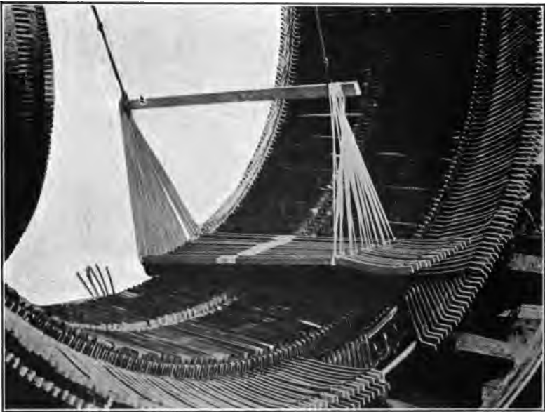
FIG. 110.—U. S. S. Tennessee : Method of Winding Main Motor Stator
